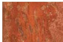
Entfernen Sie den losen Rost mit einer Drahtbürste oder einem anderen Schleifmittel. Restrost wandeln Sie am besten mit ADLER Ferrobloc um.
